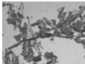
Вид частиц смеси фосфатов кальция, ун. х 20
