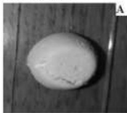
Фотография композиционного материала с содержанием наполнителя 50% при 25^\circ\text{C} , А) Однократное увеличение; Б) на сканирующем микроскопе.
