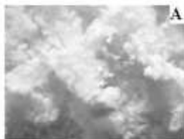
Фотографии композиционного материала с содержанием наполнителя 10%; А) t_{\text{сублим}} = 200^\circ\text{C} , Б) t_{\text{сублим}} = 25^\circ\text{C}
