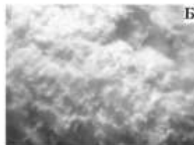
Фотографии композиционного материала с содержанием наполнителя 10%; А) t_{\text{сублим}} = 200^\circ\text{C} , Б) t_{\text{сублим}} = 25^\circ\text{C}
